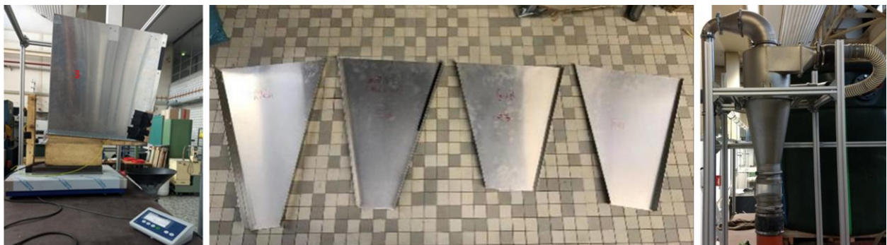
Abbildung 11: Vibrationsrinne und Waage (links), Seitenwände (Mitte), Gaszyklon (rechts)
