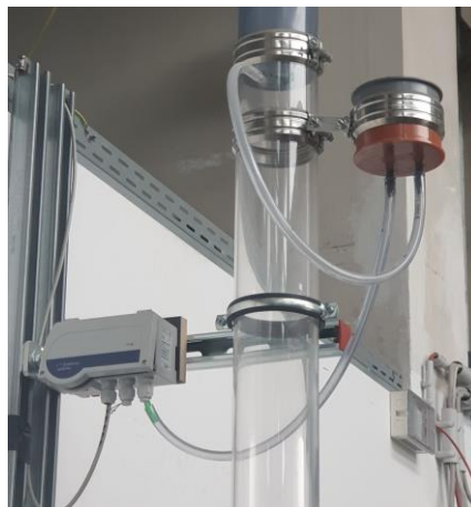
Abbildung 8: Differenzdruckaufnehmer (im Bild links) mit Staubfalle (im Bild oben rechts)
