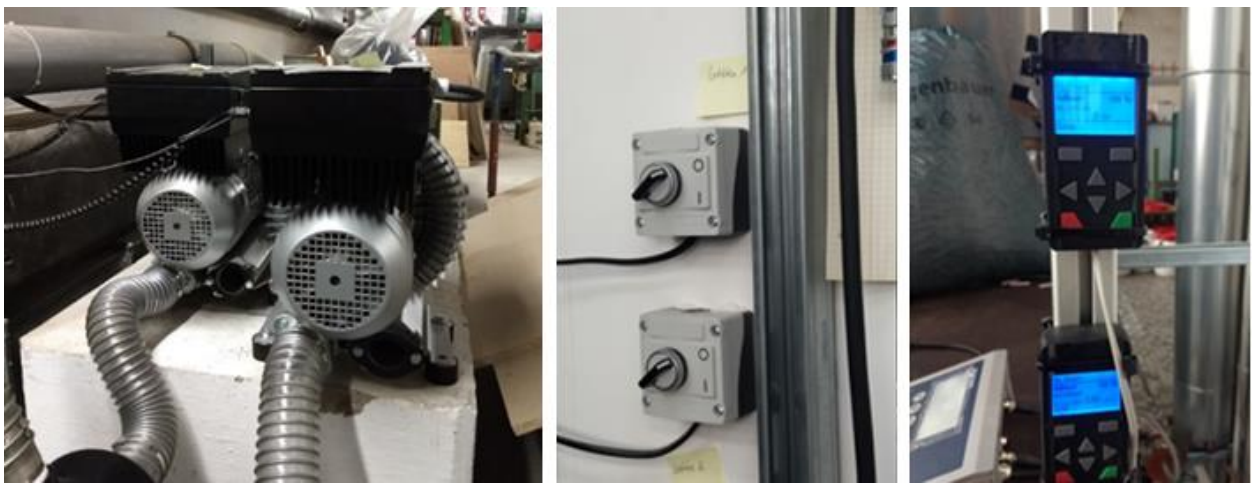
Abbildung 10: Sauggebläse (links), Hauptschalter (Mitte) und Steuereinheiten (rechts)
