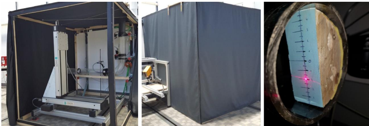
Abbildung 15: LDA- Messaufbau (links), Einhausung (Mitte), fokussierter Messpunkt (rechts)
