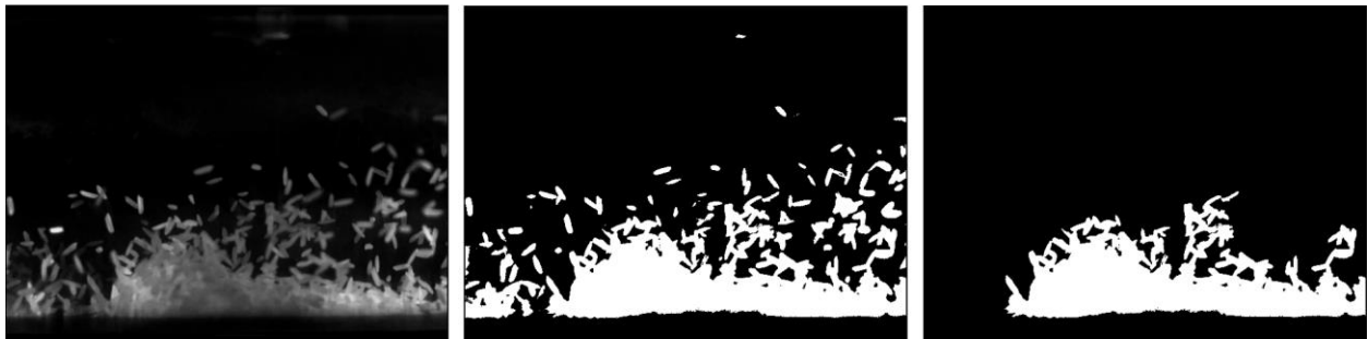
Abbildung 32: Dünenerkennung. Originalbild (links), Partikelerkennung (Mitte), größte zusammenhängende Fläche (rechts)
